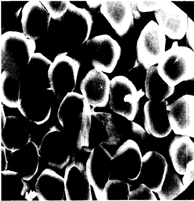
Abb. 4: Querschnitt eines mit Magnetspindeln texturieren 22/7 dtex PA 6.6-Garns (600fache Vergrößerung)
