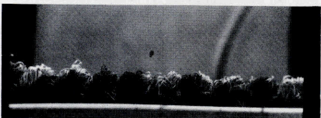
Abb. 9: Die Oberfläche von Polyester mit 3 den-Einzel-fäden (Elektronenmikroskop)
