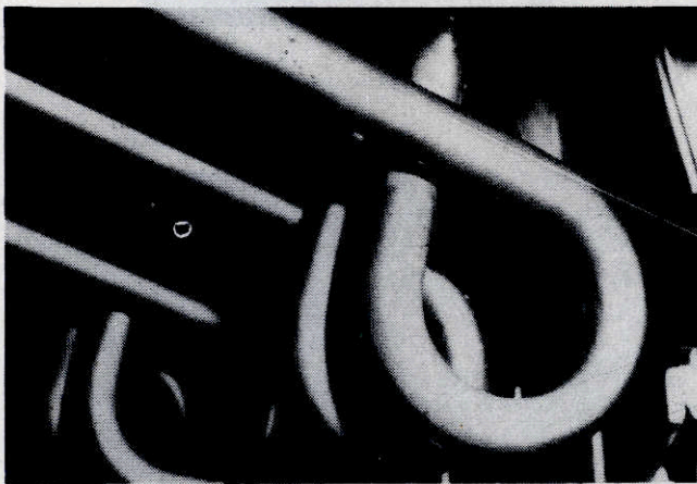
Abb. 12: Das Kontaktkühlrohr hat zwei Aufgaben: die Kühlung und Stabilisierung des Garns
