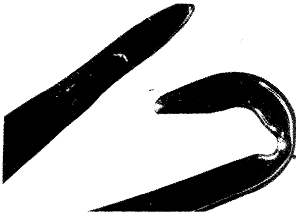
Abb. 7: Vom Garn eingesägte Nadel
