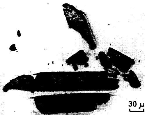
Längsbild (oben) und Querschnitt (unten) einer durch Zwirnen von PP-Folienbändchen erzeugten Splitterfaser.
