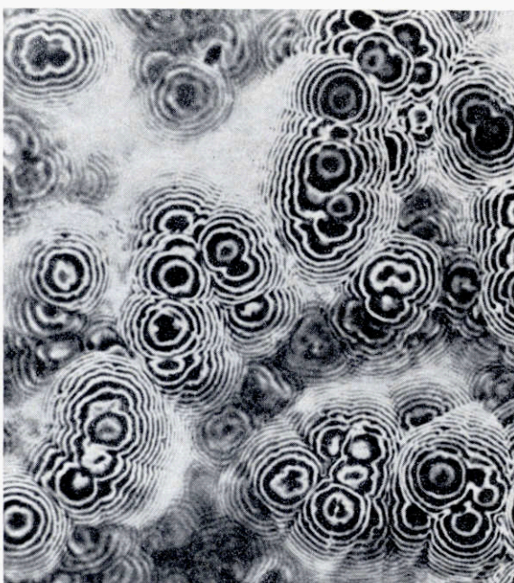
Abb. 14 Auflicht-Interferenzaufnahme einer mattverchromten Oberfläche (mit freundlicher Genehmigung der Maschinenfabrik Rieter, Winterthur)
