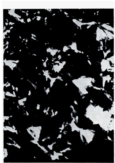
Grobsphärolithische Struktur einer Polypropylenblasfolie
