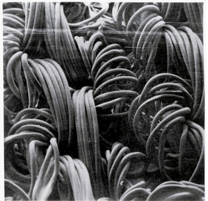
Abb. 16: StereoSm-Aufnahme eines PUE-haltigen Damenstrumpfes (Vergrößerung des in Abbildung 15 dargestellten Strumpfes). Die Einzelkapillaren des Umwindungsmaterials (Polyamidfäden) stehen infolge lockerer, mangelhafter Umwindung in weiten Spiralen vom PUE-Kern ab.
