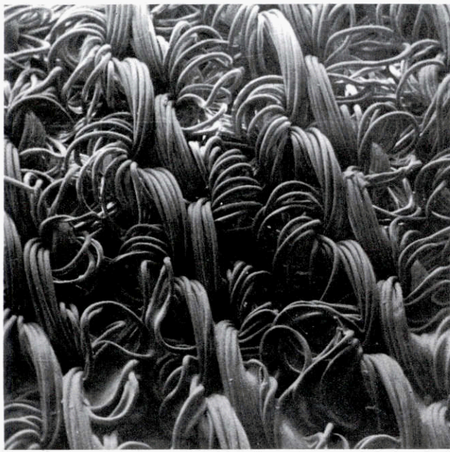
Abb. 15: Stereo-Scan-Aufnahme eines PUE-haltigen Damenstrumpfes. Neben Polyamidfäden wurde ein einfach umwundener PUE-Faden mangelhafter Qualität maschenbildend verarbeitet.
