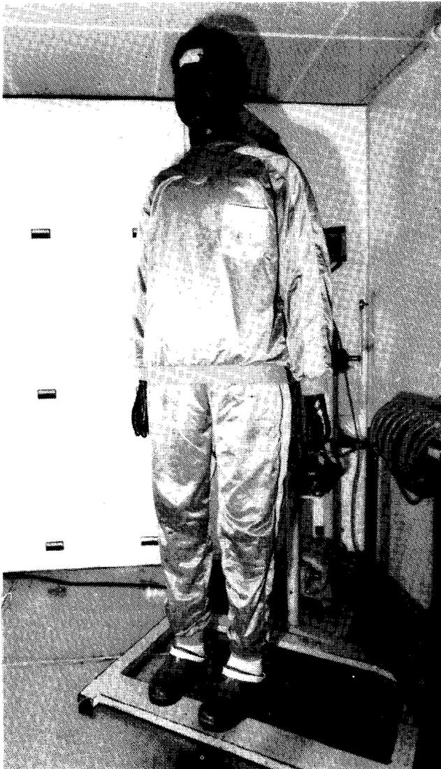
Abb. 10: Puppe Charlie mit zweiflächigem Reinraum-Unterziehanzug mit Bw-Innenseite und PES-Außenseite
