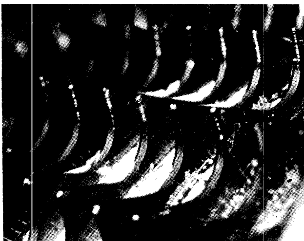
Abb. 2: Bezüge von Auflösewalzen nach 1700 Betriebsstunden bei mattierter Faser
