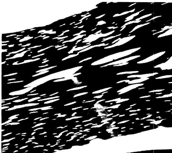
Abb. 9: Elektronenmikroskopische Querschnittsaufnahme der Folie gemäß Abbildung 7 nach der Breitenreckung, Reckverhältnis 5,0 (Vergrößerung 1640)
