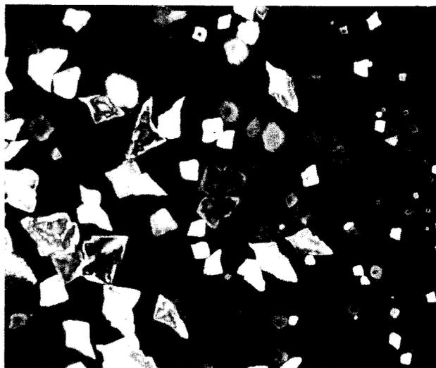
Abb. 15a: Peak 3 der HDFC-Fraktionierung des bei -30°C erhaltenen Dichlormethanextraktes von PES-Fasern (lichtmikroskopische Aufnahme; Vergrößerung: 480:1)
