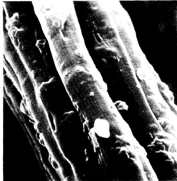
Abb. 5: Elektronenmikroskopische Aufnahme der Lenzinger schwerentflammbaren Viskosefaser (Querschnitt und Oberfläche)
