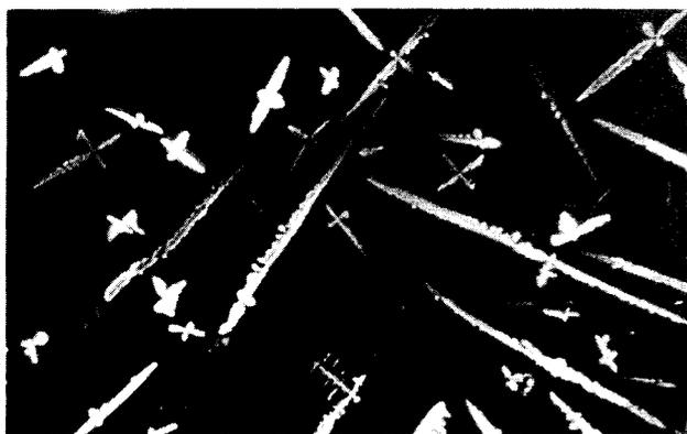
Abb. 14a: Peak 2 der HDFC-Fraktionierung des bei -30°C erhaltenen Dichlormethanextraktes von PES-Fasern (lichtmikroskopische Aufnahme; Vergrößerung: 480:1)
