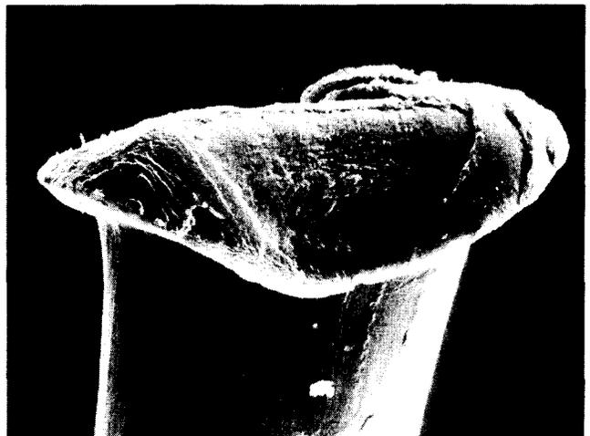
Abb. 15: Bruchstelle einer präparierten, gerissenen PP/PET-Mischfaser
