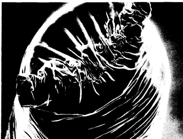
Abb. 13: Schnittstelle einer PP/PET-Mischfaser (Mantelverschweißung)
