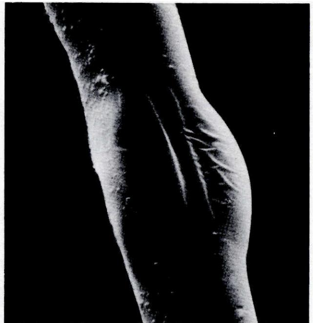
Abb. 1: REM-Aufnahme eines „Quellungsbauches“ nach Behandlung mit Tetrachloräthylen bei  $-10^{\circ}\text{C}$  (Vergrößerung: 1600:1)
