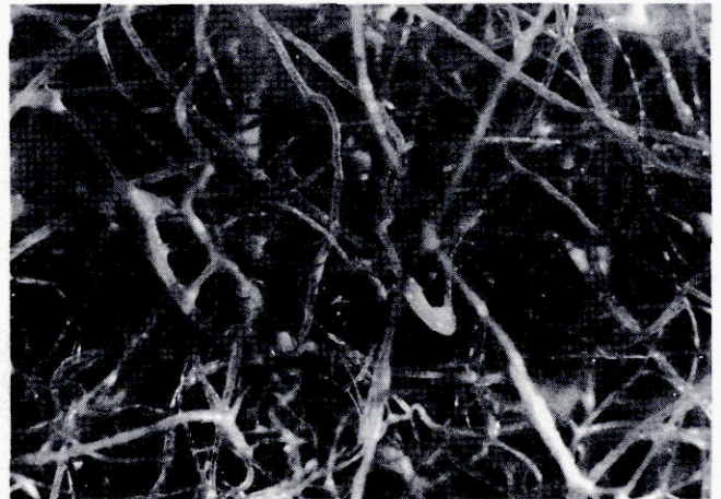
Abb. 13: PA-Fasern, kunstharzgebunden; regenerierbare Grobfiltermatte (Staubluftseite)
