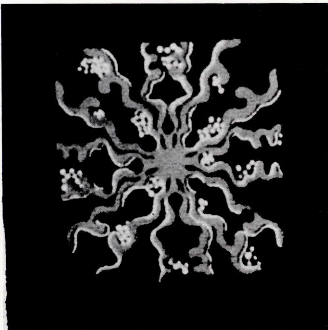
Abb. 14: Polyamid-Teppich: Reservedruck mit Sandospace® R. Einbadige Färbung mit Säure- und Dispersionsfarbstoffen
