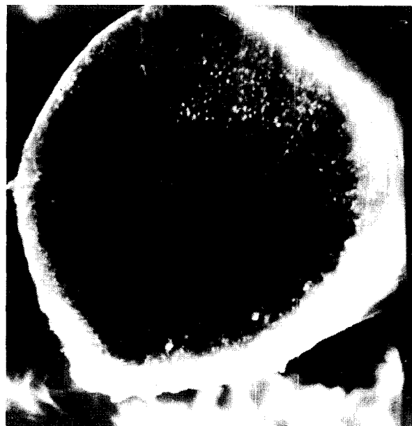
Abb. 3: Stereoscan-Aufnahme einer PES-Faser, bei der keine Migration stattfand
