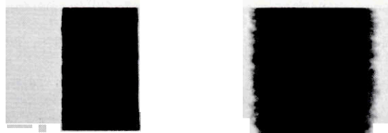
Abb. 5: Einfluß der verwendeten Verdickungen beim Polyamid-Flockteppichdruck
