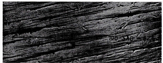
Abb. 10: Elektronenmikroskopische Aufnahme und Trockenanschmutzung einer Polyacrylnitrilversuchsfaser (IV), M = 8000:1
