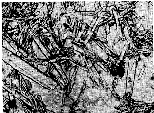
Abb. 8: Äußerst dichter Oligomerenbelag auf dem Zwischenteller; Entnahme: Montag
