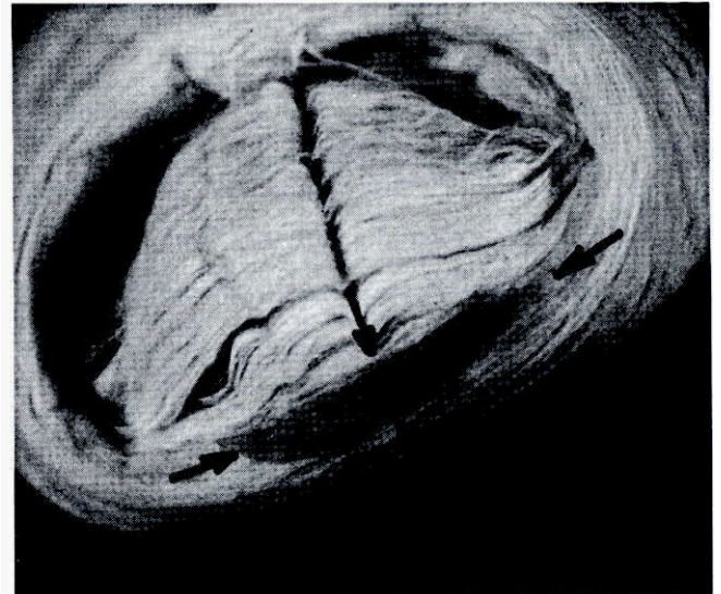
Abb. 14. Schwarzweiß-Aufnahme eines gelben Polyester-muffs mit grün verfarbtem Innenteil (zwischen den Pfeilen)
