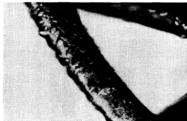
Abb. 3: Faseroberfläche mit vertemperten Oligomeren
