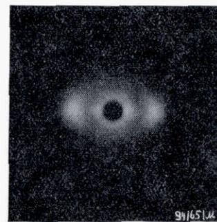
Abb. 11: Röntgen-Weitwinkel-Diagramm, Dacron® 61 HS
