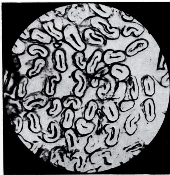
Fig. 1. Baumwolle im Querschnitt. Links normal, rechts gequollen. Vergleich identischer Einzelfasern im linken und rechten Bild zeigt, daß die Quellung gering ist
