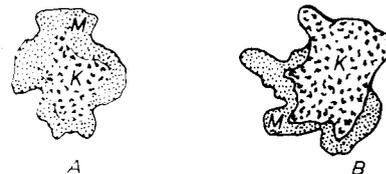
Querschnittstruktur einer normalen Viskosefaser (A = Kern/Mantelstruktur) und einer modernen hochgekräuselten Viskosefaser (B = Side by Side-Struktur)
