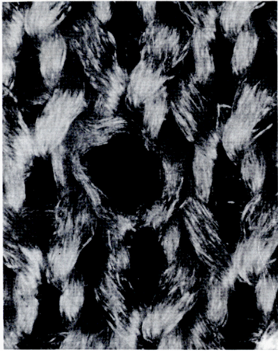
Abb.7: Beschädigung des Nähgutes durch Wärmeentwicklung beim Nahen
