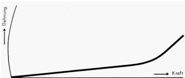
Abb. 4: Original Kraft-Dehnungsdiagramm einer elastischen Sehne im gegerbten Zustand (aufsteigender Kurvenast bedeutet plastische Dehnung)
