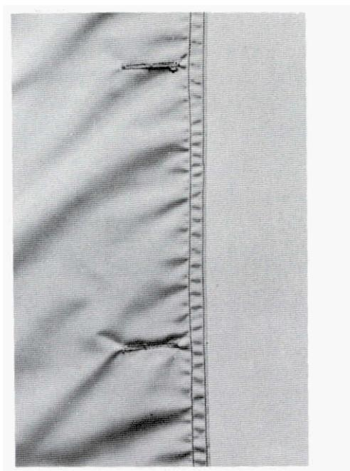
Abb. 14: Kantenbesatz angenäht; Kante zweimal gesteppt
