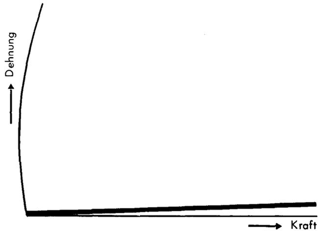
Abb. 2c: Original Kraft-Dehnungsdiagramm einer kollagenen Sehne im gegerbten wie ungegerbten Zustand
