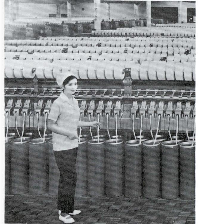
Abb. 7: Spinnerei Fukui von Daiwa, Japan, ausgerüstet mit vierzig, von Toyoda, Japan, 1968 in Lizenz hergestellten BD 200 mit Kannenvorlage 230 x 700 mm und 15 kg Spulengewicht
