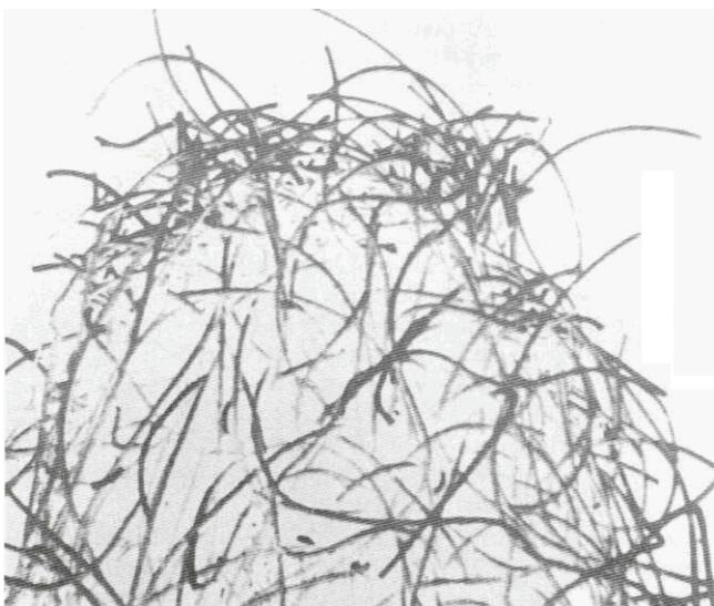
Abb. 15: Morphologie der Noppenspitze in einem Teppich mit Schnittpol aus Polyester-Bikomponentenfaser (ausgerüstet)
