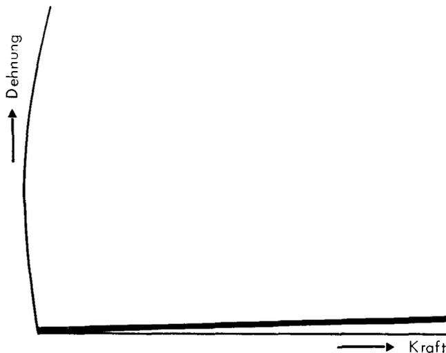
Abb. 2b: Original Kraft-Dehnungsdiagramm einer elastischen Sehne im gegerbten Zustand
