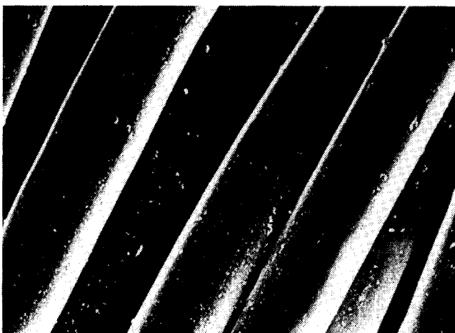
Abb. 13: Faseroberfläche aus Bild 12 nach 12 Haushaltswäschen und sechsmaliger chemischer Reinigung
