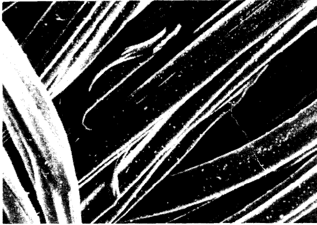
Abb. 18: Oberfläche von PES-Fasern gepropft mit einer Kombination von Methylen-bis-acrylamid und einem niedermolekularen Vinylphosphonsäureäthylenglykolester
