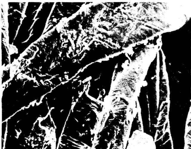
Abb. 2: Oberfläche einer schwerentflammbaren, harzausgerüsteten Baumwolle (REM-Aufnahme)
