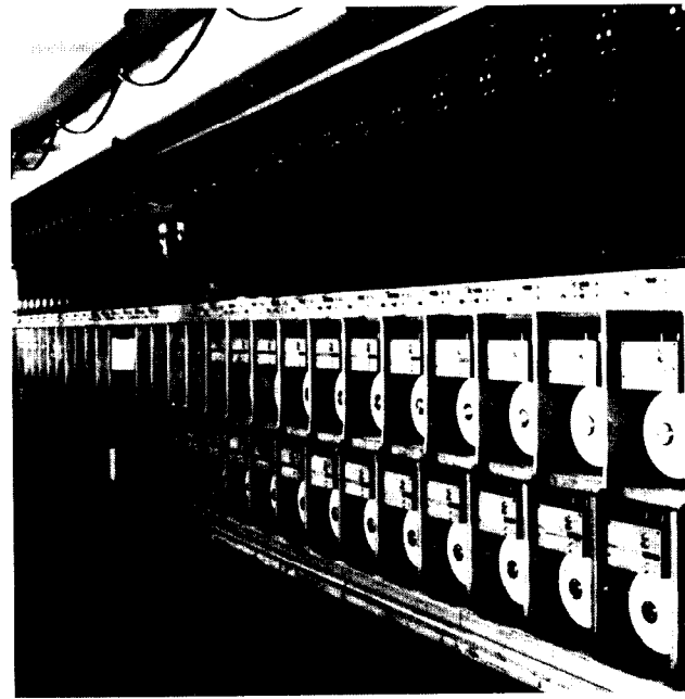
Abb. 13: Moderne POY-Spinnerei ohne Abzugsgaletten
