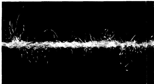
Abb. 11: Heterogarn aus Polyester- und Viskosefilamenten mit freien Faserenden
