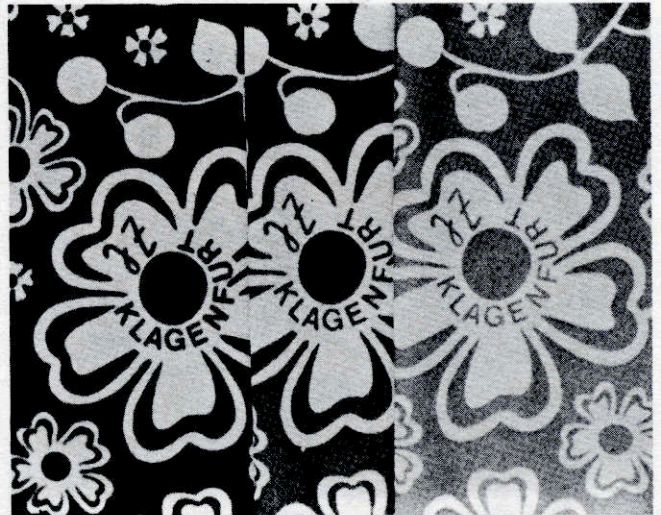
Abb. 7: Varianten mittels Magnetrakelsystem beim Rundschablonen-Direktdruck auf ein Polyestergewebe
