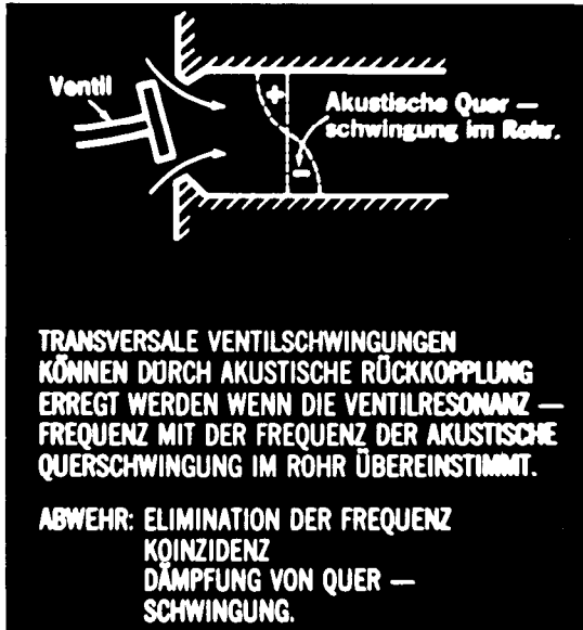
Abb. 14: Schallabwehr bei Ventilschwingungen;
